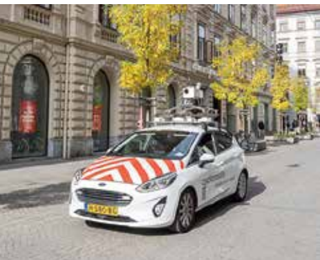
Das Cyclomedia-Aufnahmefahrzeug mit Dachkamera erstellt hochauflösende 360°-Panoramabilder des öffentlichen Raums wie hier in Graz.
