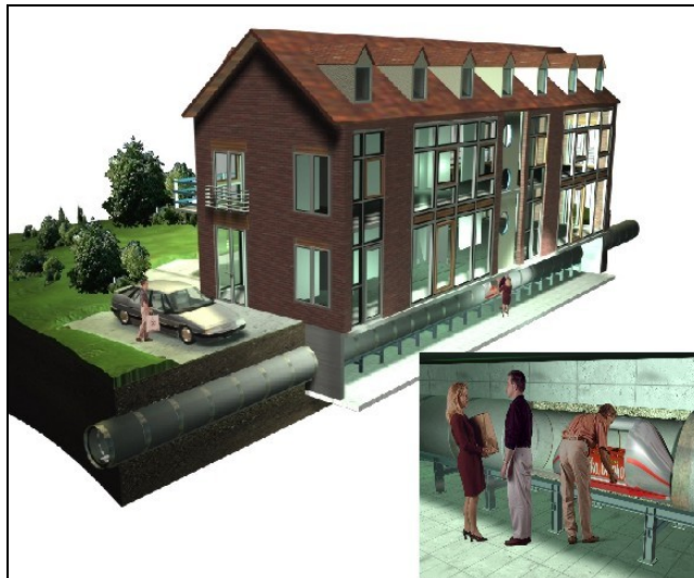
Bild 7: Hausanschluss als Vision des CargoCap-Konzeptes
