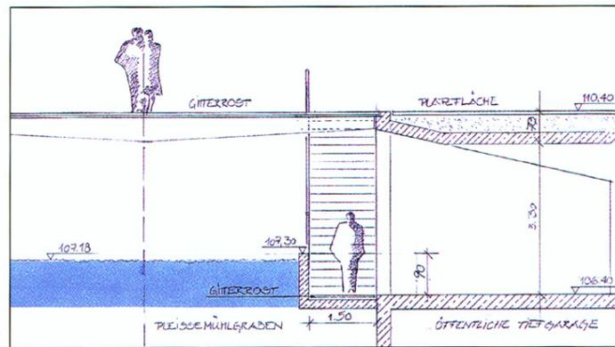
Schnitt des Tiefgaragenausgangs
